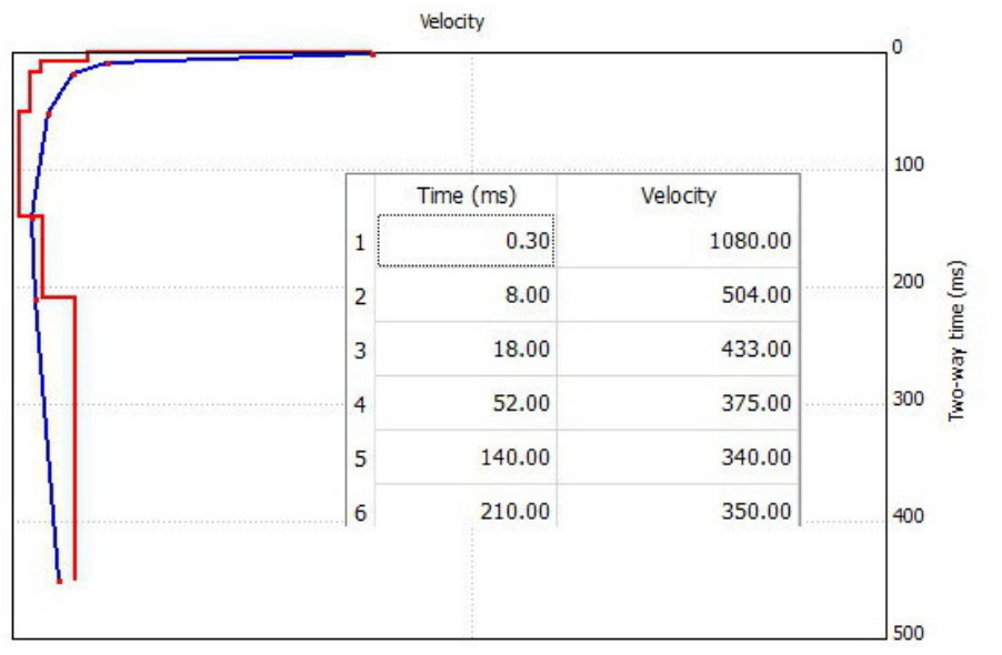
Abb. 5: Generalisiertes Geschwindigkeitsmodell nach der oberflächenseismischen Bearbeitung; die blaue Kurve und die Tabelle zeigen den Stapelgeschwindigkeits-verlauf, die rote Linie die sich ergebenden Intervallgeschwindigkeiten nach DIX.
