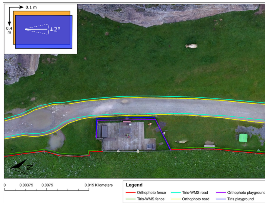
Abb. 4: Räumliche Genauigkeit des georeferenzierten 3D-Modells mit Angabe der Winkeltreue, basierend auf SfM von UAS-Photographien. Die räumliche Ungenauigkeit liegt bei 0.1-0.4 m. GCP wurden nur mit einem Garmin Montana 600 eingemessen und nicht mit einem DGNSS.
