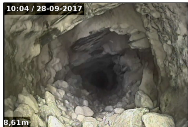
Abb. 4: Bohrlochammerabefahrung in einer Erkundungsbohrung (links: intaktes Gebirge; rechts: zerlegter Bereich)
