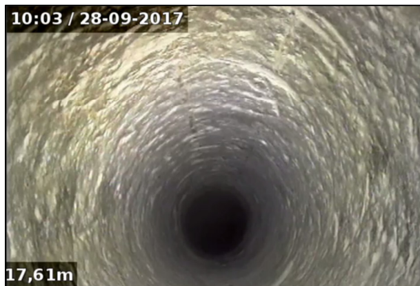
Abb. 4: Bohrlochammerabefahrung in einer Erkundungsbohrung (links: intaktes Gebirge; rechts: zerlegter Bereich)
